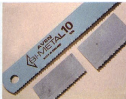
图1 电子束焊接的双金属锯条 [6]
