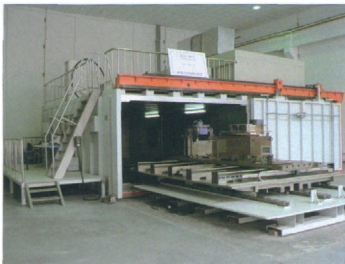
图2 成飞公司引进的电子束焊机ZD150-30C CV65M
